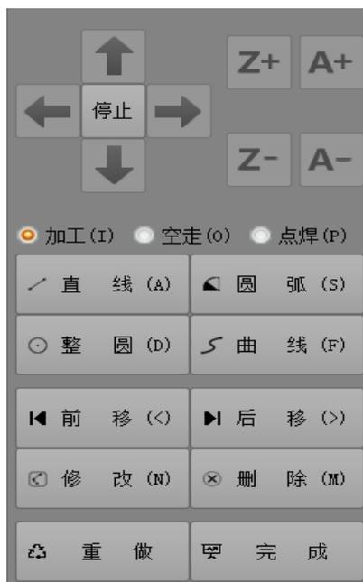
◎加工 (I): 指该段路径为加工路径, 激光、气阀都会同时 打开;
